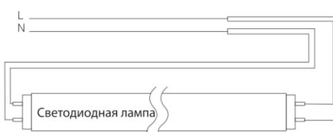
Слева схема подключения обычной люминесцентной лампы в светильник с электронным балластом (дросселем), справа схема подключения светодиодной лампы в этот светильник. Необходимо выполнить подключение светодиодной трубы в обход дросселя как изображено на схеме справа. Для подключения светодиодной трубы в этот тип светильника требуется внесение изменений в конструкцию светильника.
